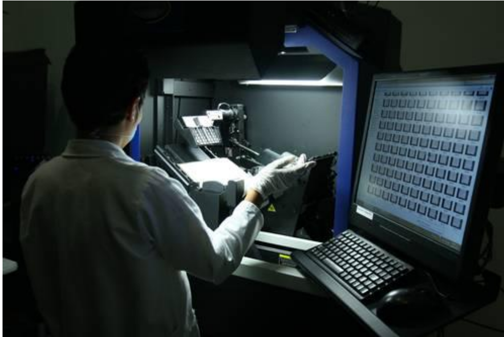
EL ESCÁNER AUTOMÁTICO CAMBIA CON UNAS PINZAS CADA HOJA DEL EJEMPLAR PARA OBTENER LA RÉPLICA. EN ESTE “ROBOT” SE HA LOGRADO LA CONVERSIÓN DE ALREDEDOR DE MIL 800 PÁGINAS EN 60 MINUTOS. FOTO MARÍA MELÉNDREZ PARADA
