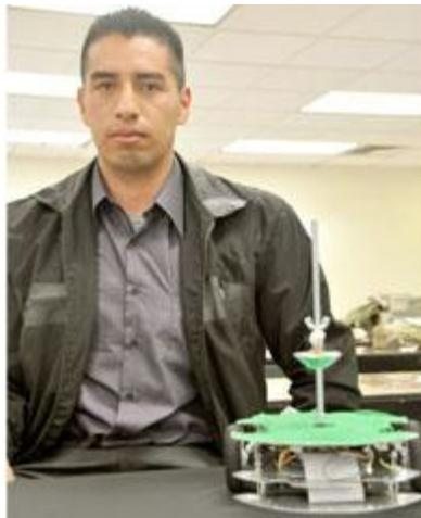
El robot que desarrolló Humberto Mejía, alumno de la Unidad Profesional Interdisciplinaria en Ingeniería y Tecnologías Avanzadas del Instituto Politécnico Nacional (IPN), es un explorador que puede ser utilizado para inspeccionar planetas gracias a sus sistemas de desplazamiento omnidireccional, visión periférica y detección de objetos.
